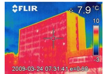
La thermographie nous a permis de constater le manque général d'isolation des bâtiments ainsi que les ponts thermiques. L'intérêt de la simulation a été de mettre en évidence les postes de déperditions de l'enveloppe du bâti, mais aussi de pouvoir quantifier précisément les gains énergétiques de chaque proposition faite.
